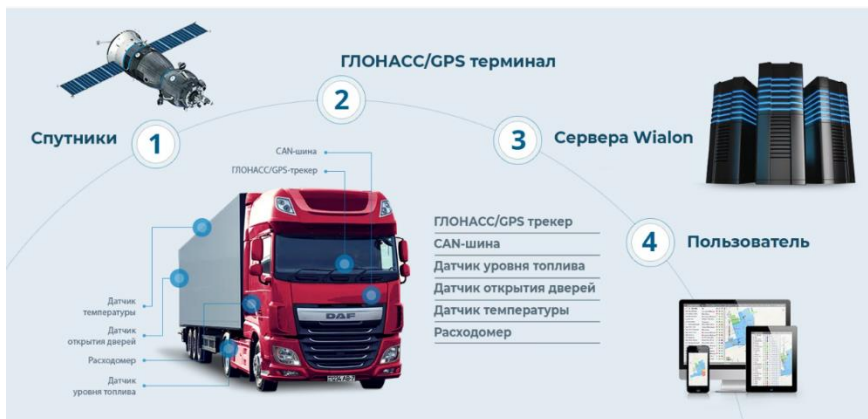
Рисунок 3. 3 - Общая схема спутникового мониторинга транспорта
