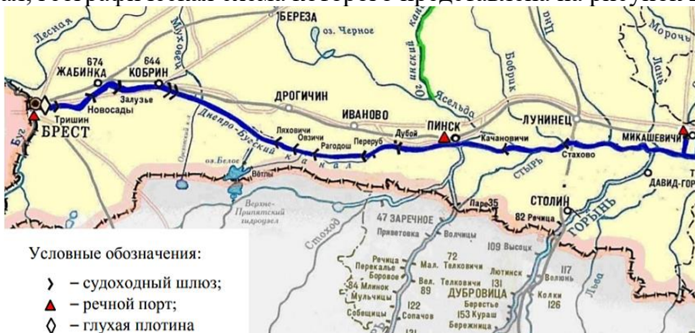
Рисунок 2.14. Схема Днепро-Бугского канала (Беларусь)
